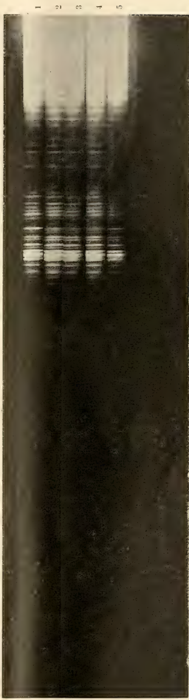
Solución de clorhidrato de morfina al 1 por mil en \text{CO}_2\text{Na}_2 al 3 por mil
