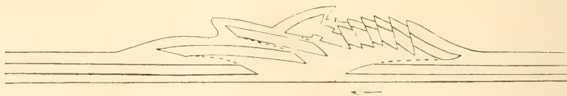
Fig. 11. — Una capa de arena húmeda entre dos capas de arena casi seca. Sobreescurremientos largos de las escamas anchas en el frente de la cuña
